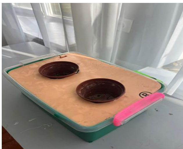
Фото 1, 2. Экспериментальная малогабаритная гидропонная установка
