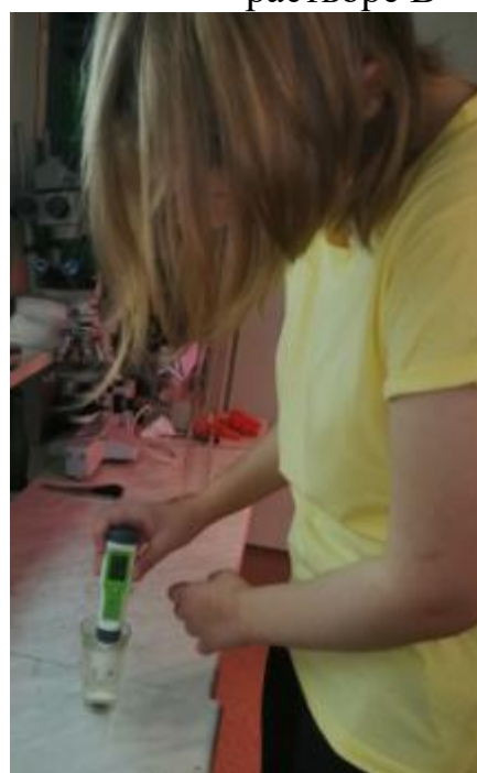
Рис. 6. Измерение pH питательного раствора гидропонной установки
