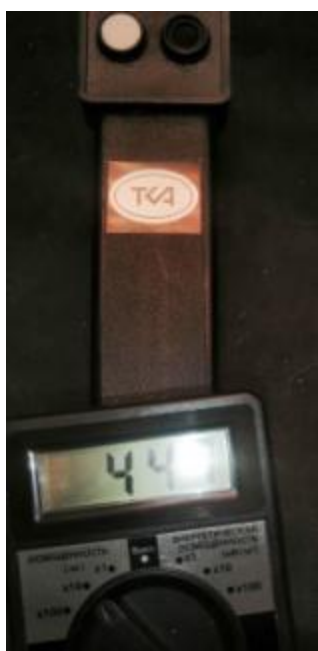
Рис.17 Показание мощности освещения в гроу тенте (4470 лк)
