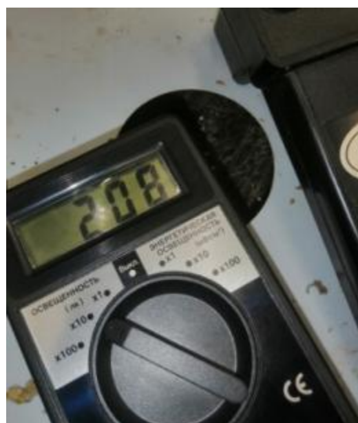
Рис.18 Показание мощности освещения на полке с томатами на гидропонике (2080 лк)
