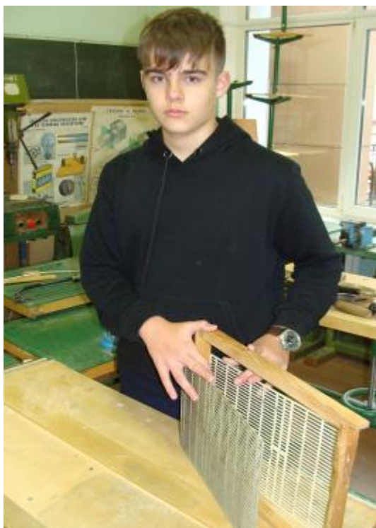
Фото 2. Закрепление решетчатых боковых стенок на каркасе изолятора
