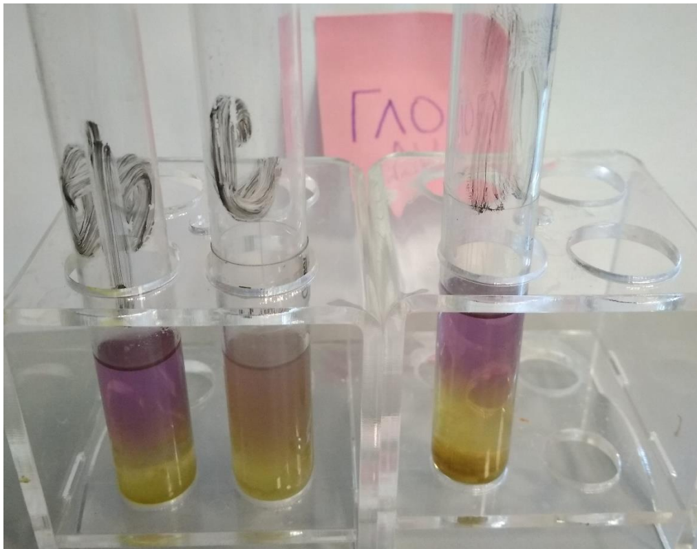
Рис. 4. Определение содержание глобулинов: Ф – белковый раствор фасоли, С- белковый раствор сои, Г – белковый раствор гороха.
