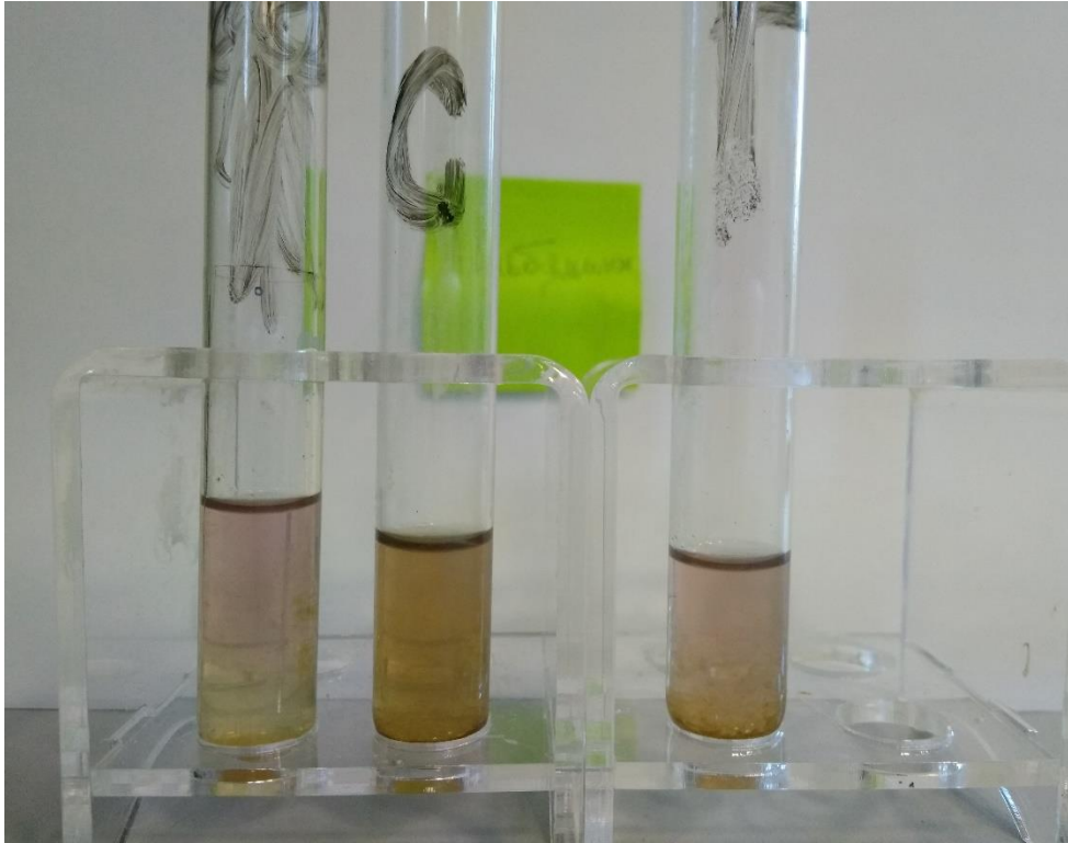
Рис. 3. Определение содержание альбуминов: Ф – белковый раствор фасоли, С- белковый раствор сои, Г – белковый раствор гороха.
