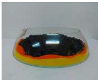
Керамзин покрыт землей выровнено 2 уровня песка – вид сбоку
