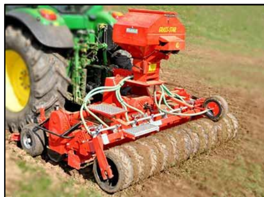
Рисунок 4. Сельхозмашины производства Einböck GmbH & CoKG: а) штригель Grass-Manager + сеялка Pneumaticstar, б) сеялка Grass-Star. Фотографии с сайта agrobases.ru (АгроБаза, 2006–2019).
