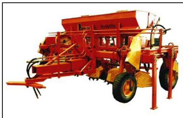
Рисунок 5. а) Сеялка дернинная СДК-2,8 компании Авитек; б) Орудие для полосного подсева семян трав ОПШ, производства КазНИИМЭСХ Фотографии с сайта agrobases.ru (АгроБаза, 2006–2019).
