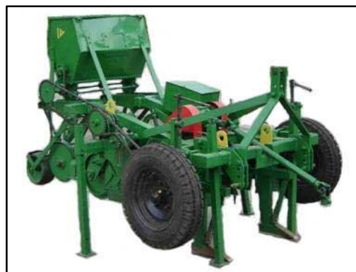
Рисунок 5. а) Сеялка дернинная СДК-2,8 компании Авитек; б) Орудие для полосного подсева семян трав ОПШ, производства КазНИИМЭСХ Фотографии с сайта agrobases.ru (АгроБаза, 2006–2019).
