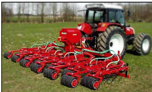
Рисунок 4. Сельхозмашины производства Einböck GmbH & CoKG: а) штригель Grass-Manager + сеялка Pneumaticstar, б) сеялка Grass-Star. Фотографии с сайта agrobases.ru (АгроБаза, 2006–2019).
