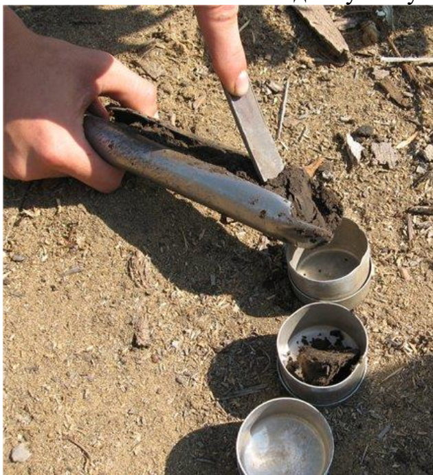
Рисунок 5 – Отбор почвенных образцов для определения влажности почвы
